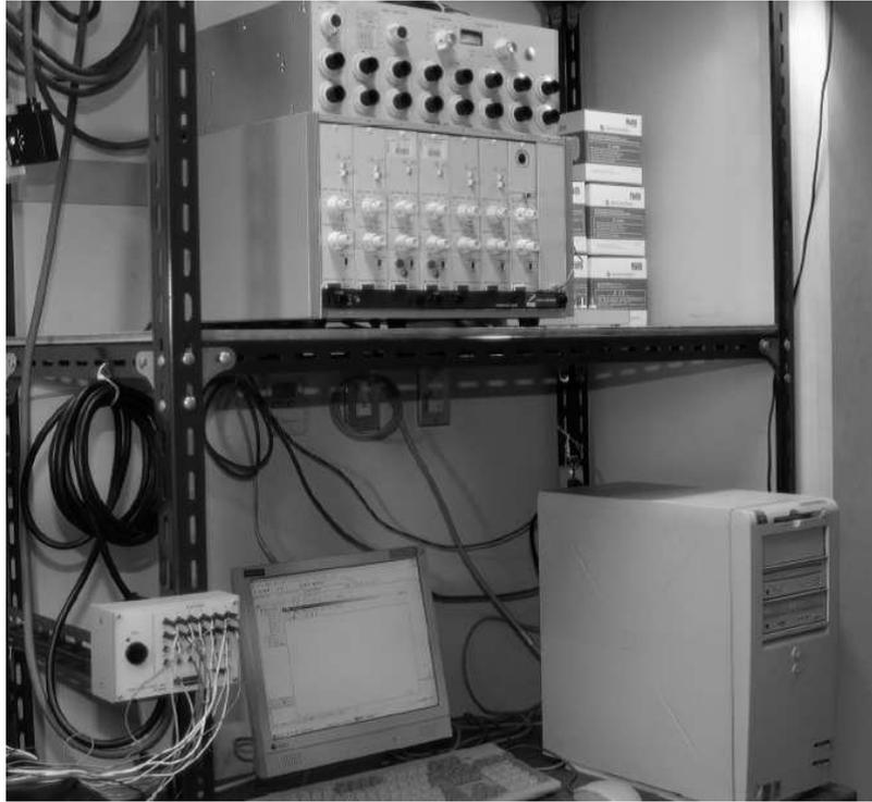
図 3.1.2 表面筋電位計測装置
