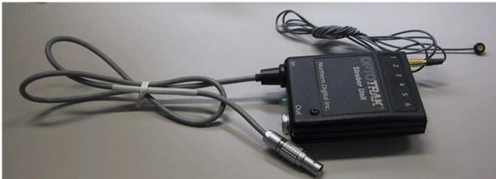
図 3.1.4 Optotrak System (LED)
