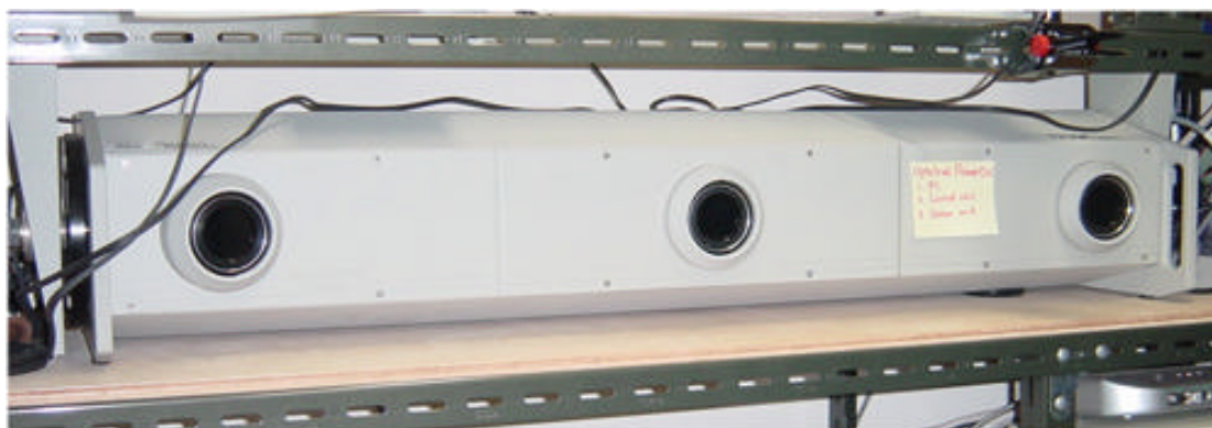
図 3.4(b) Optotrak System (CCD センサ)
