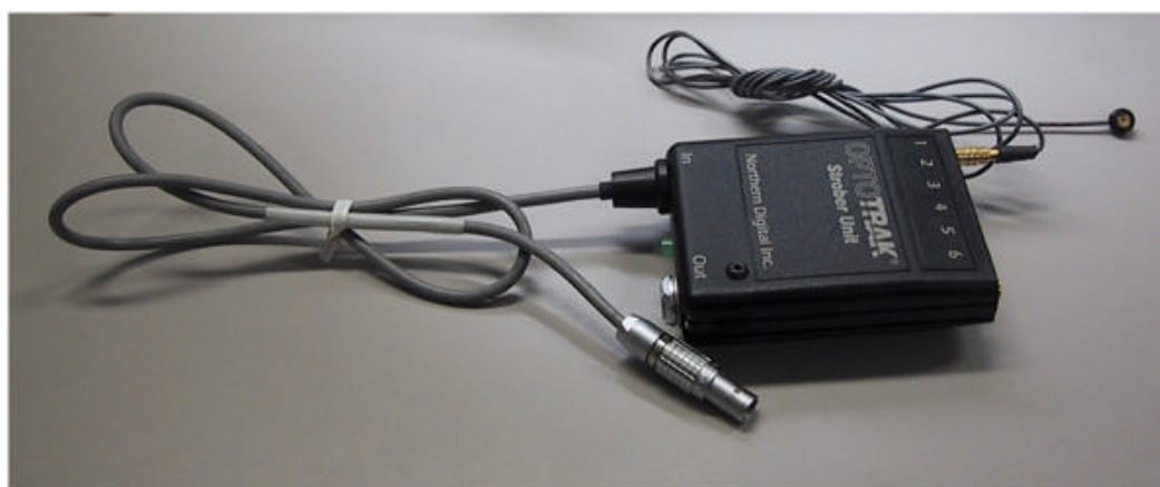
図 3.4(a) Optotrak System (LED マーカ)
